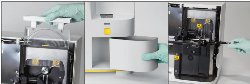
7. Die Schutzabdeckung der Zentrifuge, den Abfallbehälter und die Tropfschale entfernen. Dann mit warmem Wasser reinigen und anschließend mit einem neuen trockenen optischen Reinigungstuch trocknen.
