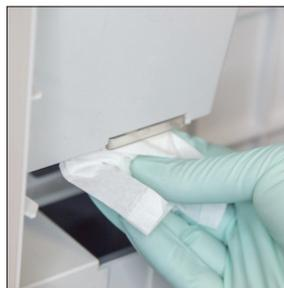
2. Die Tür des Analysegeräts öffnen und Ober- wie Unterseite des Messfensters mit einem optischen Reinigungstuch reinigen. Anschließend mit einem trockenen optischen Reinigungstuch trocknen.
