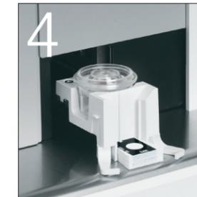
4. セパレーターを機器本体の所定の位置にセットして、測定を開始します。
