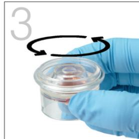
3. Durch mindestens fünfmaliges behutsames Schwenken des Vollblutseparators (**nicht schütteln oder umdrehen**) wird die Probe mit dem darin enthaltenen Antikoagulans vermischt.
