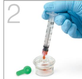
2. **Immédiatement** après le prélèvement de l'échantillon (pour éviter la coagulation), déposez 0,6–0,8 cc de sang total **non traité** (sans additif) dans le séparateur de sang total traité à l'héparinate de lithium. Pour cette opération, utilisez une seringue sans aiguille et non traitée.
