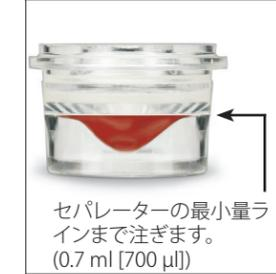
**備考:** シリンジの目盛りを確認して、適切な量のサンプルを移してください。
