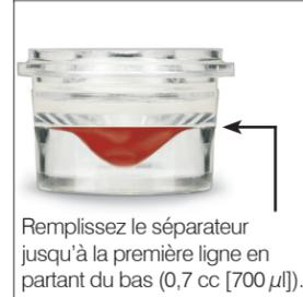
**Conseil :** Pour garantir l'exactitude du volume de remplissage, utilisez la ligne de remplissage située sur le séparateur.
