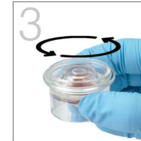
3. セパレーターを5回以上、水平左右にゆっくりと回して、血液検体と抗凝固剤を混和させます (転倒混和したり、振ったりしないでください)。
