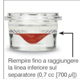
**Suggerimento:** Utilizzare la linea di riempimento sul separatore per ottenere il corretto volume di riempimento.
