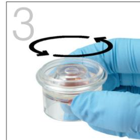
3. Mescolare delicatamente (**non capovolgere o agitare**) il separatore di sangue intero per almeno 5 minuti per miscelare il campione con l'anticoagulante.
